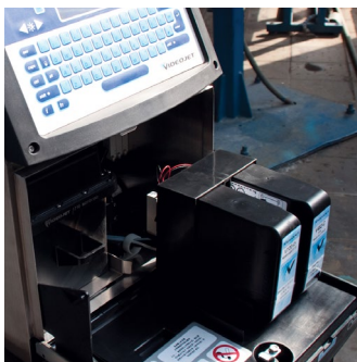
Système de distribution Smart Cartridge™ dans le codeur Videojet 1710
